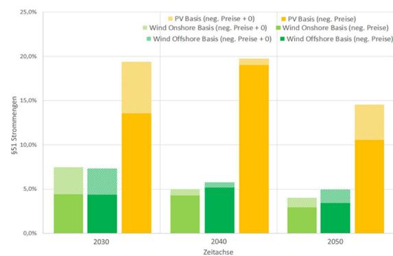
Im Hinblick auf die hohe Photovoltaikeinspeisung verlagert sich die Häufigkeit des Auftretens negativer Strompreise deutlich in den Tagesbereich (siehe Abb. 4). Dies führt – wie in Abb. 5 zu sehen – zu einer drastischen Erhöhung nicht geförderter solarer Einspeisung von 10-20 % der Jahreseinspeisung über die kommenden Dekaden, was wiederum den wirtschaftlichen Betrieb einschränkt und somit den klimapolitisch notwendigen Ausbau begrenzt.
